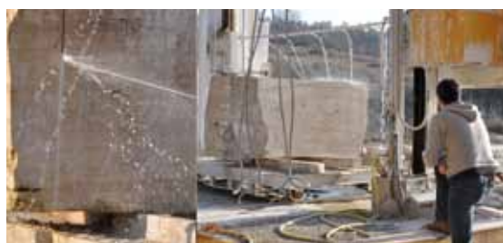
Taglio del travertino per il basamento presso la ditta Traverini Paradiso di Rapolano.
